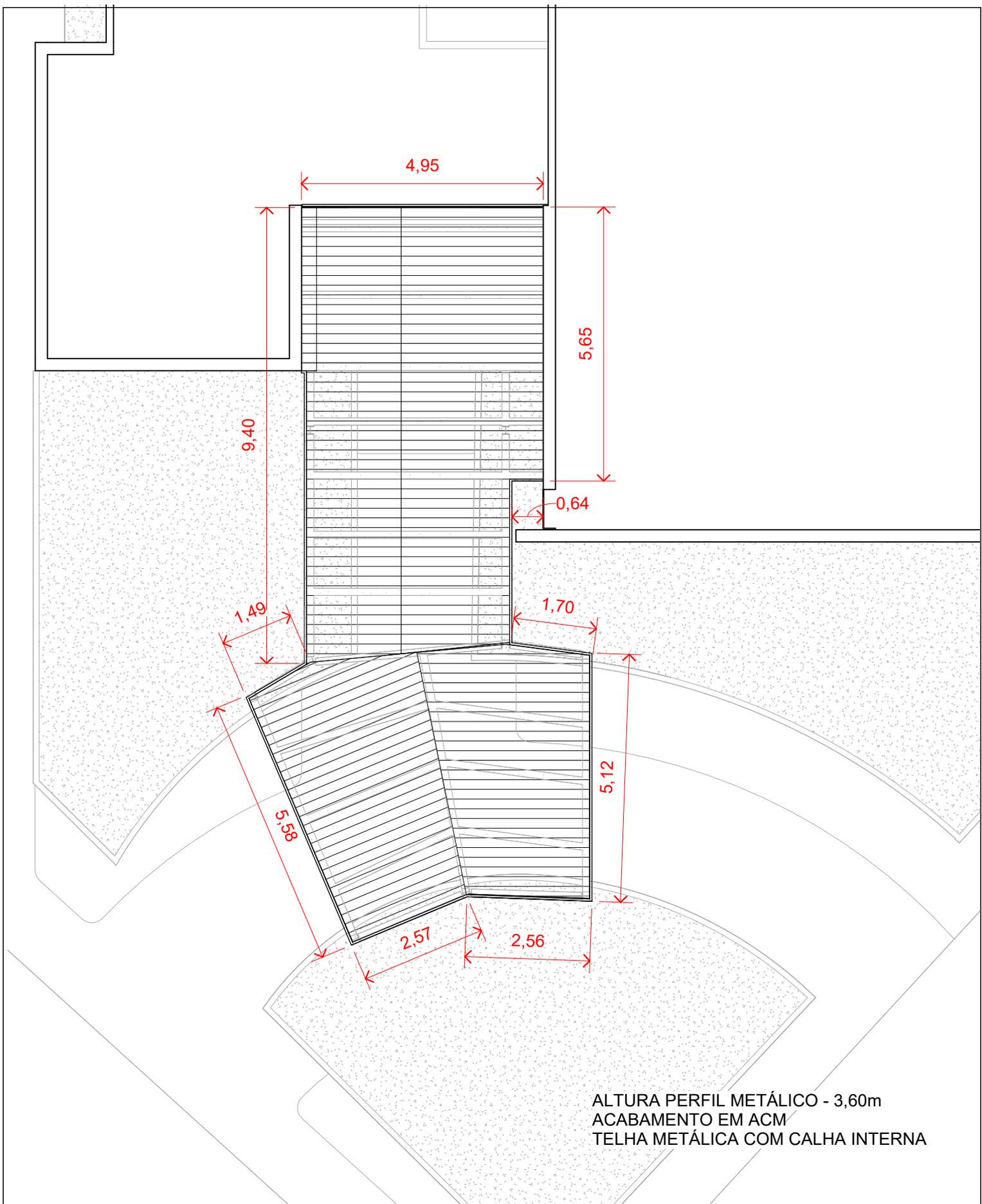
ALTURA PERFIL METÁLICO - 3,60m
